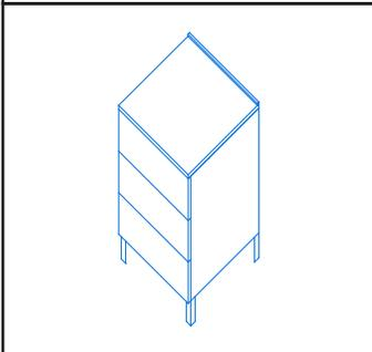
Barra de 90cm de altura con superficie de krion (KR) color snow white mate (BL) con soclo en la parte posterior. Estructura rectangular de 4 patas hecha con ángulos de acero (AC), 2 tapas laterales, 1 tapa posterior y 2, 3 ó 4 cajones de lámina de acero (AC) pintados de color blanco (BL) con pintura electrostática.
