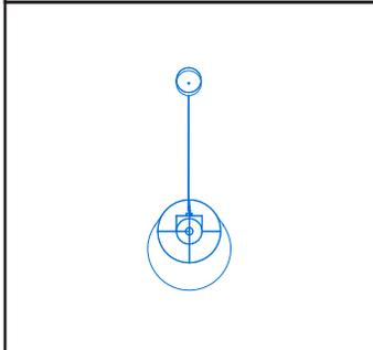
Lámpara de techo (TE) de 23.7 cm de altura y 50 cm de diámetro de lámina de acero (AC) pintada de color blanco (BL) con pintura electrostática.
