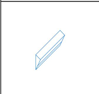
Lámpara de muro (MU) de 20 cm de altura y 15 cm de ancho de lámina de acero (AC) pintada de color blanco (BL) con pintura electrostática.
