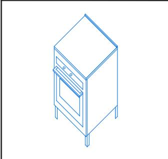
Barra de 90cm de altura con superficie de krion (KR) color snow white mate (BL) con soclo en la parte posterior. Estructura rectangular de 4 patas hecha con ángulos de acero (AC), 2 tapas laterales y 1 tapa posterior de lámina de acero (AC) pintadas de color blanco (BL) con pintura electrostática. Con horno.
