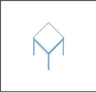
Superficie rectangular sobre estructura de 4 patas hecha con ángulos de acero (AC), pintada de color blanco (BL) con pintura electrostática.
