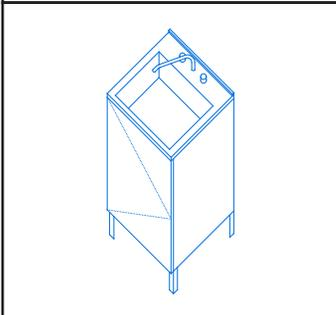
Barra de 90cm de altura con superficie de krion (KR) color snow white mate (BL) con soclo en la parte posterior. Estructura rectangular de 4 patas hecha con ángulos de acero (AC), 2 tapas laterales, 1 tapa posterior, una repisa rectangular a 15cm de altura y una puerta de lámina de acero (AC) pintadas de color blanco (BL) con pintura electrostática. Con tarja de corian color glacier white (BL).
