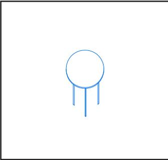
Superficie circular sobre estructura triangular de 3 patas hecha con ángulos de acero (AC), pintada de color blanco (BL) con pintura electrostática.
