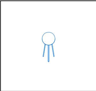
Banco circular de 30 cm de diámetro de lámina de acero (AC) sobre estructura triangular de 3 patas inclinadas hecha con ángulos de acero (AC), pintado de color blanco (BL) con pintura electrostática.
