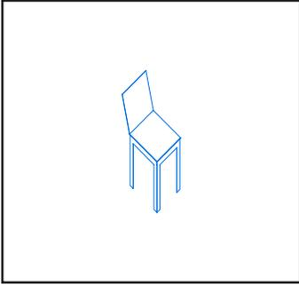
Silla de 45 cm de altura, 35 cm de largo y 30 cm de ancho de lámina de acero (AC) sobre estructura rectangular de 4 patas hechas con ángulos de acero (AC) pintada de color blanco (BL) con pintura electrostática.
