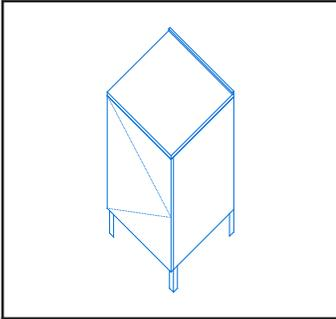
Barra de 90cm de altura con superficie de krion (KR) color snow white mate (BL) con soclo en la parte posterior. Con estructura rectangular de 4 patas hecha con ángulos de acero (AC), 2 tapas laterales, 1 tapa posterior, 2 repisas rectangulares y una puerta de lámina de acero (AC) pintadas de color blanco (BL) con pintura electrostática.
