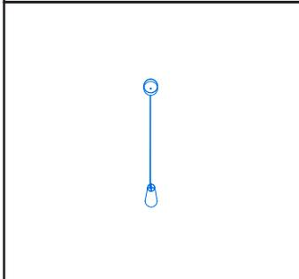
Lámpara de techo (TE) de 10 cm de altura y 9 cm de diámetro, de lámina de acero (AC) pintada de color blanco (BL) con pintura electrostática.
