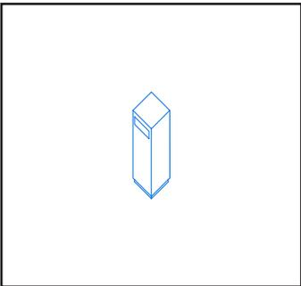
Basurero rectangular de lámina de acero (AC) con estructura rectangular hecha con ángulos de acero (AC) pintado de blanco (BL) con pintura electrostática.
