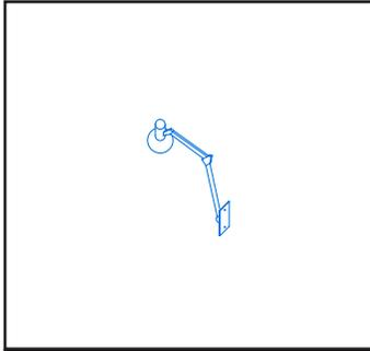
Lámpara de muro (MU) de 73 cm de altura y 15 cm de diámetro de aluminio (AL) pintado de blanco (BL) con pintura electrostática.
