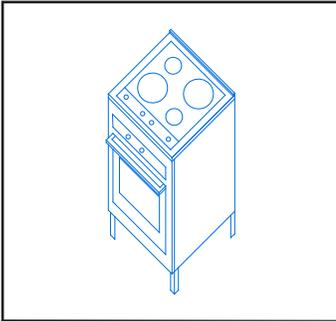
Barra de 90cm de altura con superficie de krion (KR) color snow white mate (BL) con soclo en la parte posterior. Estructura rectangular de 4 patas hecha con ángulos de acero (AC), 2 tapas laterales y 1 tapa posterior de lámina de acero (AC) pintadas de color blanco (BL) con pintura electrostática. Con horno y parrilla.
