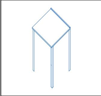
Barra de 90cm de altura con superficie de krion (KR) color snow white mate (BL) con soclo en la parte posterior. Con estructura rectangular de 4 patas hecha con ángulos de acero (AC) pintada de color blanco (BL) con pintura electrostática.
