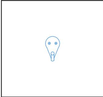
Perchero de muro (MU) sencillo de 4.2 cm de largo y 2.2 cm de ancho de níquel (NI) pintado de color blanco (BL) con pintura electrostática.
