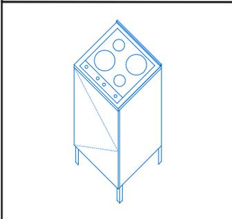
Barra de 90cm de altura con superficie de krion (KR) color snow white mate (BL) con soclo en la parte posterior. Estructura rectangular de 4 patas hecha con ángulos de acero (AC), 2 tapas laterales, 1 tapa posterior, 2 repisas rectangulares y una puerta de lámina de acero (AC) pintadas de color blanco (BL) con pintura electrostática. Con parrilla.
